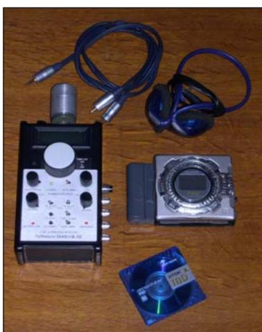
À cette fin, nous avons enrichi ponctuellement l'équipement d'un détecteur d'ultrasons Pettersson D-980 pour la différenciation oiseaux/chiroptères des mouvements à basse altitude détectés par radar. Pour être plus performant dans le positionnement des Chiroptères et dans l'analyse de leur comportement, nous avons également utilisé un amplificateur de lumière et une caméra IEEE 1394 AVT utilisée seule ou avec une lampe halogène.
